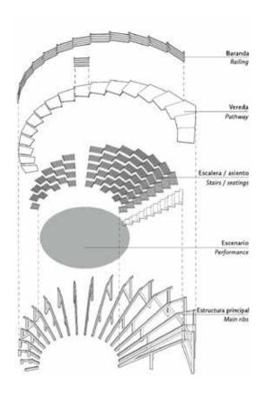
Isométrica despliegue de elementos / Isometric showing elements S. E. / N. S.
