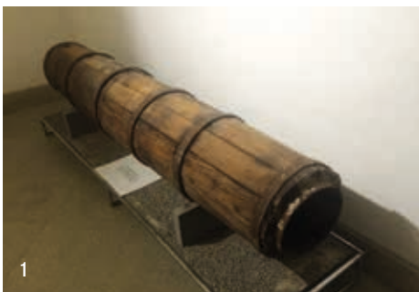
1 Leitung aus Holz (Holzteuchel) 2 Leitung aus Eternit mit Korkdämmung 3 heutige Leitung aus Polyethylen mit PUR-Dämmung (PE)
