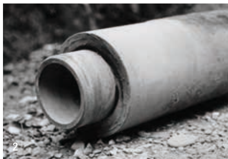
1 Leitung aus Holz (Holzteuchel) 2 Leitung aus Eternit mit Korkdämmung 3 heutige Leitung aus Polyethylen mit PUR-Dämmung (PE)
