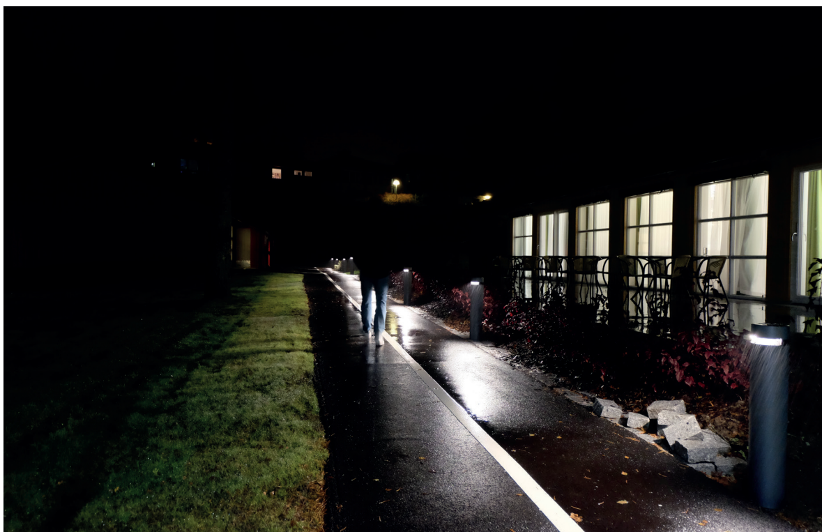
Illustrasjon 27: Ved pullertbelysning kastes mindre lys til omgivelsene, et fondelement i enden av stien ville bidratt til økt lesbarhet. Foto: Helga Iselin Wåseth
