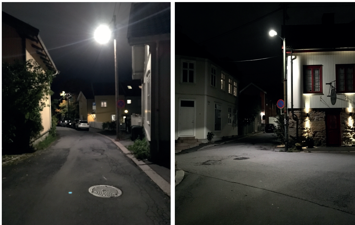
Illustrasjon 43 og 44: Foto av to master, én med avskjerming og én uten. Armaturen med avskjerming blander tydelig mindre enn armatur uten avskjerming. Foto: Helga Iselin Wåseth
