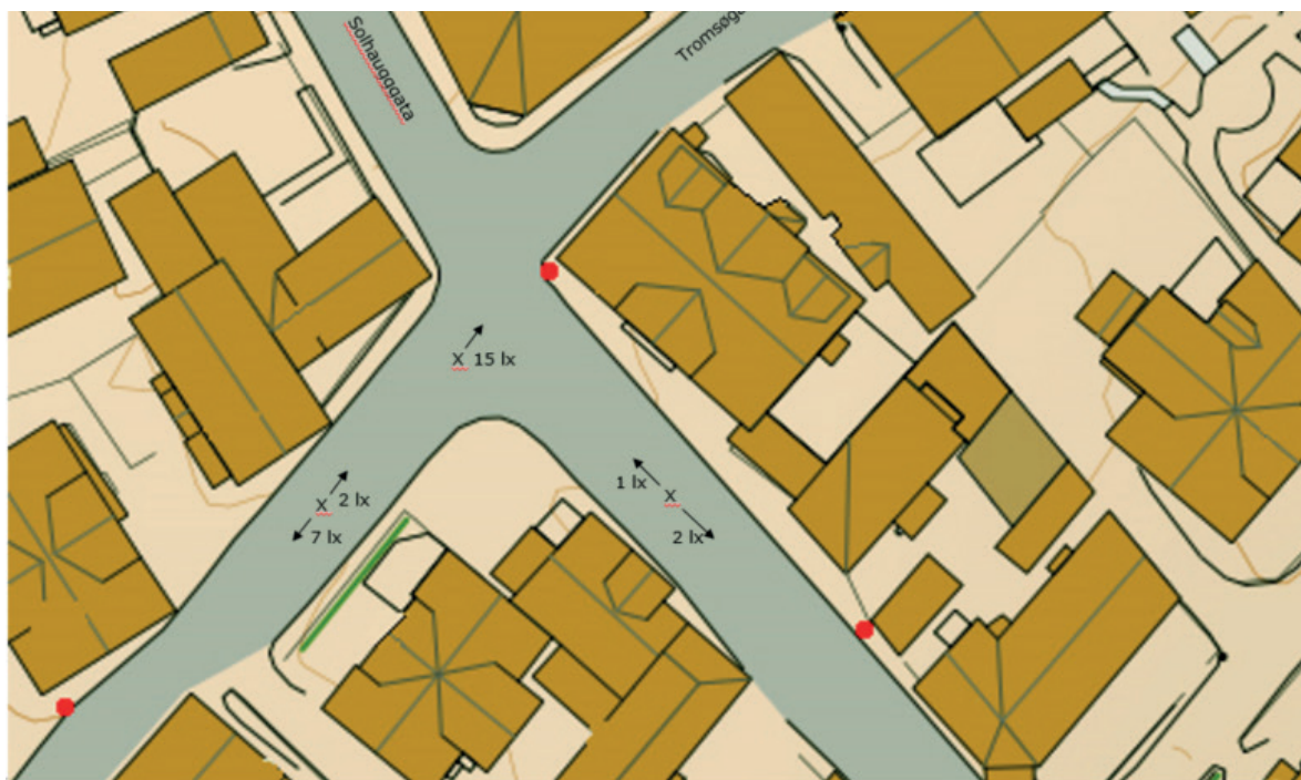
Illustrasjon 45: Måling av lysnivå i hodehøyde og i synsretning.
