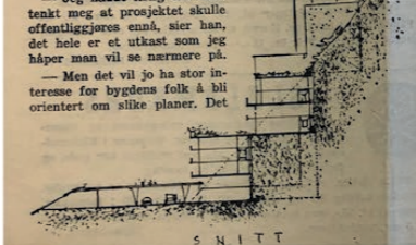
Snitt som viser hvordan bygget blir liggende i terrenget. Nedre del av hestesjakkten er sprengt inn i fjellet. Under bygget blir det plass til garasjer.
