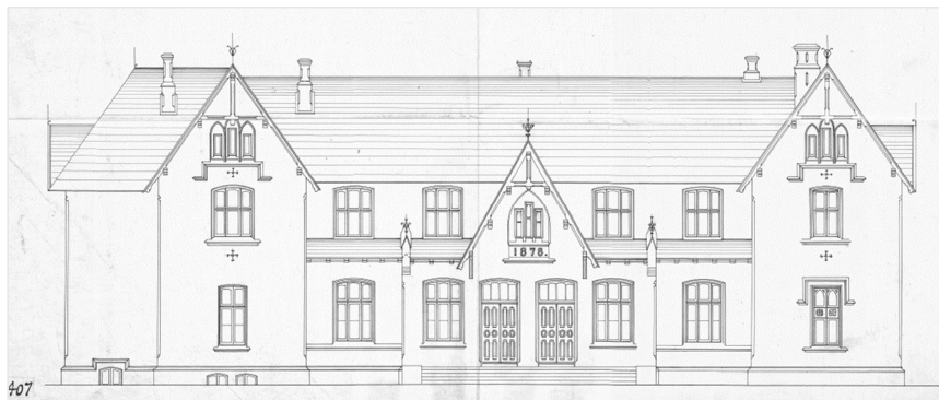
Figur 26 Stasjonsbygningens østfasade Originaltegning oppbevares hos Bane NOR Eiendom. Tegningen er tekstet som en kopi, utført av Solveig Abrahamson i 1905.
