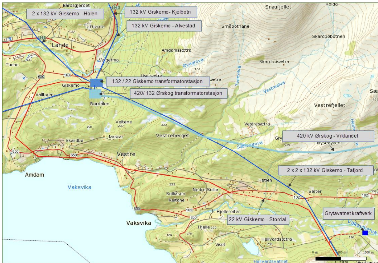
Figur 2.2.10.2 Nettbilde alle spenningsnivå mellom Grytuvatnet kraftverk og 420 kV sentralnett.
