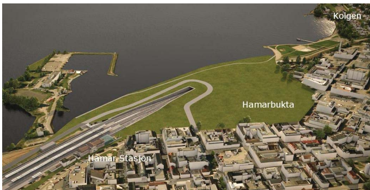
Figur 12: Korridor K1 vest med kulvert slik det var foreslått i 2016. Hamarbukta er fylt ut mellom kulverten og sentrum. Strandlinja, som har vore definerande for byforma, er her flytt bort frå sentrum. Jernbaneverket kravde høg utnytting og utbygging på det utfylte arealet for å byggja opp under knutepunktet. Illustrasjon: Jernbaneverket (2016a, 116).
