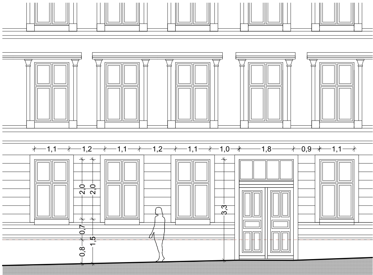
Figur 18 Fasade mot øst, Steenstrups gate 14 - 1:75
