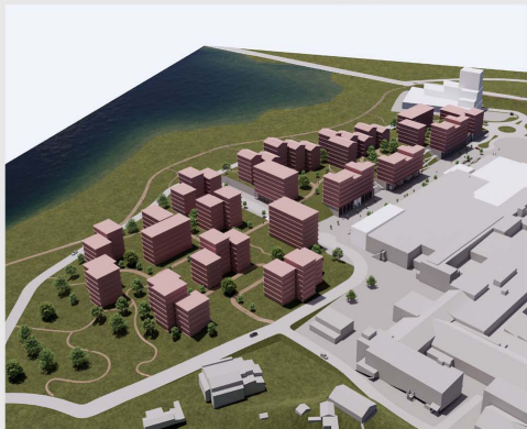
2: I dette alternativet er det subtile endringer på takformene i forhold til basisalternativet. Bygningsvolumene trappes fortsatt ned mot vannet, men de trappes også litt ned fra øst til vest, for å følge landskapet fra sentrum mot vannet.
