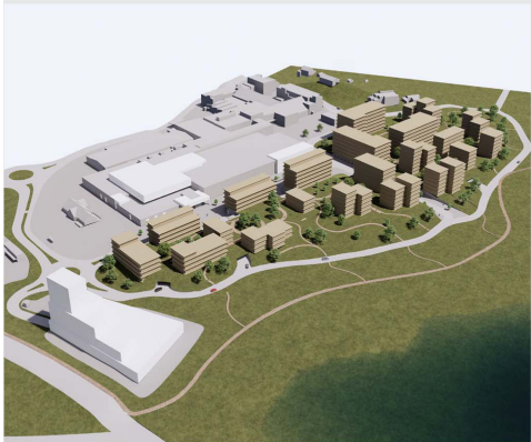
2: I dette alternativet er det subtile endringer på takformene i forhold til basisalternativet. Bygningsvolumene trappes fortsatt ned mot vannet, men de trappes også litt ned fra øst til vest, for å følge landskapet fra sentrum mot vannet.
